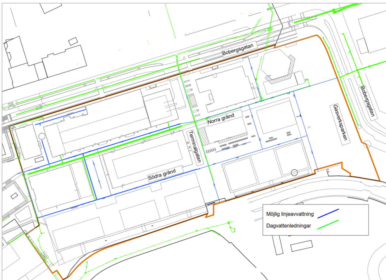
Figur 11. Planerat ledningssystem synligt som gröna linjer i bild, möjligt system för linjeavvattning eller motsvarande synligt som blå linjer i bild.
