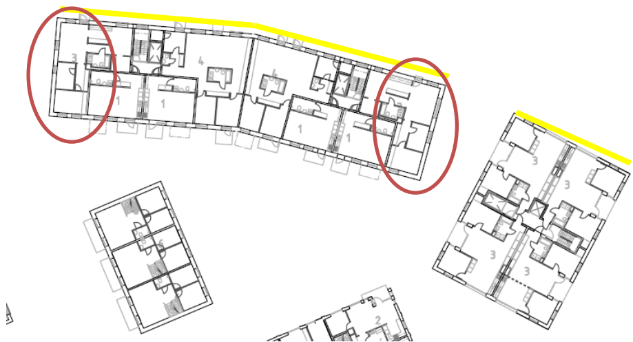
Figur 5. Normalplan för bullerexponerade hus i kv B. Bullerexponerade fasader markeras med gult streck. Inringade gavellägenheter behöver någon åtgärd för att skapa en bullerskyddad sida även för maxnivåerna.
