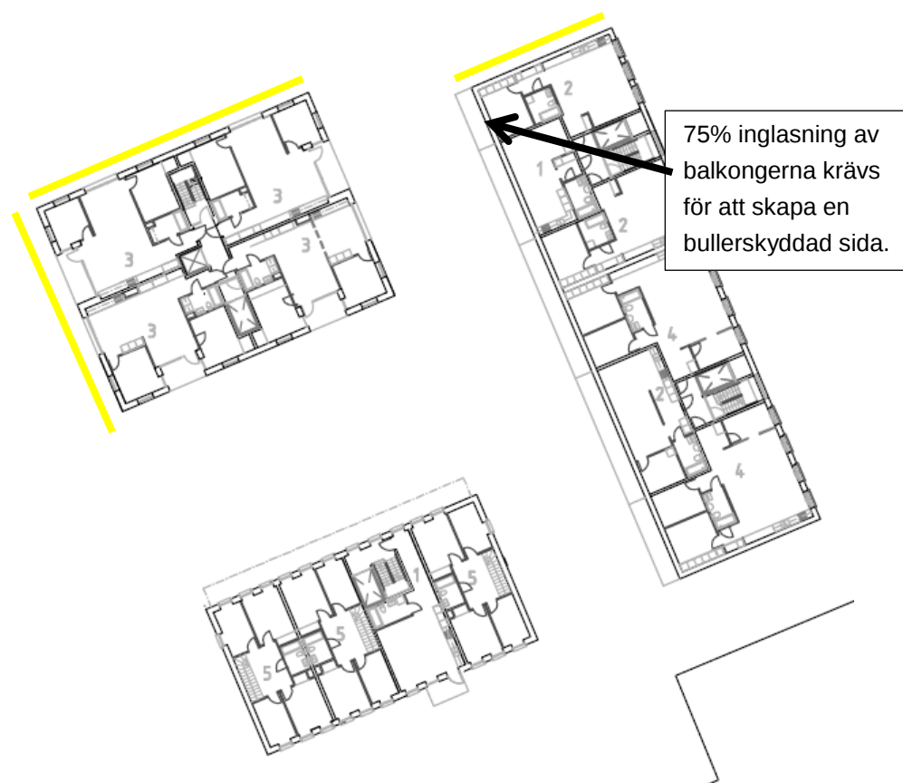
Figur 7. Normalplan för bullerexponerade hus i kv C. Bullerexponerade fasader markeras med gult streck.
