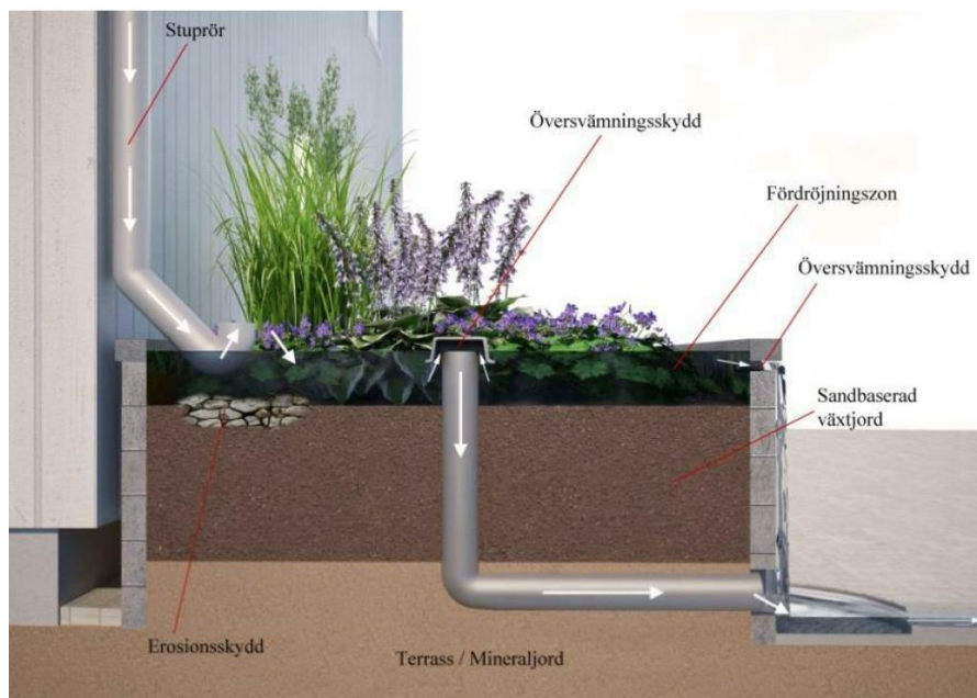
Figur 21 Principskiss för biofilter upplyft konstruktion. (Bildkälla: Grågröna systemlösningar för hållbara städer, Inventering av dagvattenlösningar för urbana miljöer, Vinnova 2014.)
