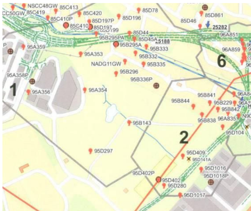
Figur 2. Observationsrör för grundvatten på och vid Årstafältet.
