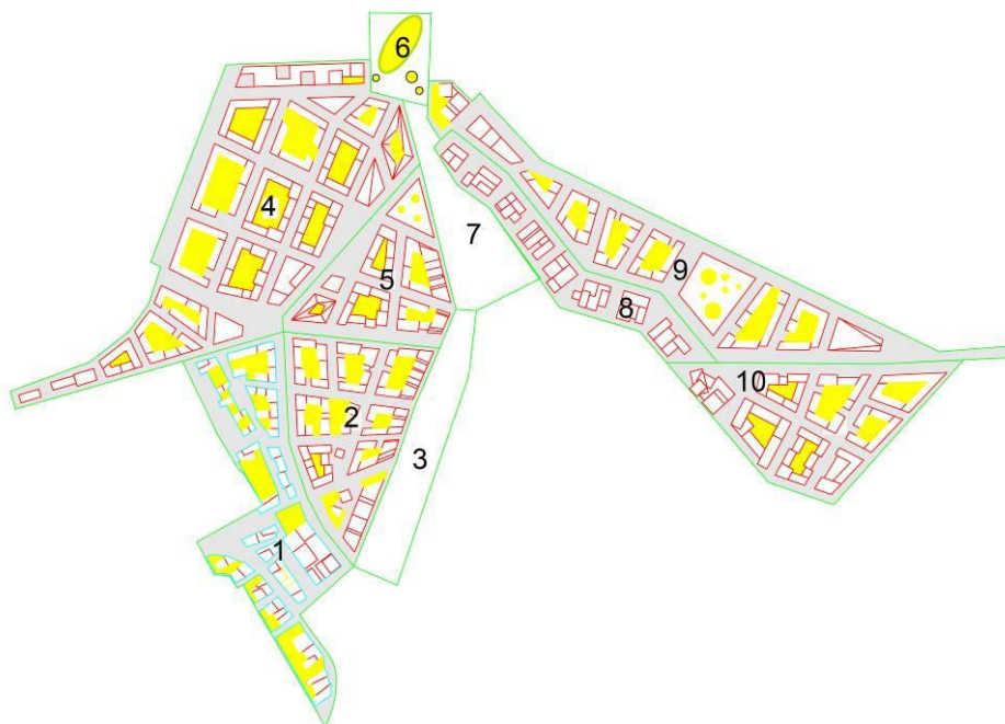
Figur 6. Planförslag och delavrinningsområden.
