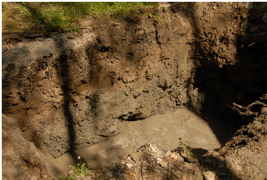
Figur 5.14. Provgrop 6 med två olika sorters fyllningsmaterial och ett kraftigt inflöde av grundvatten som i en kanal i den undre (blå) fyllningsleran. Bilden togs 2011-07-07.
