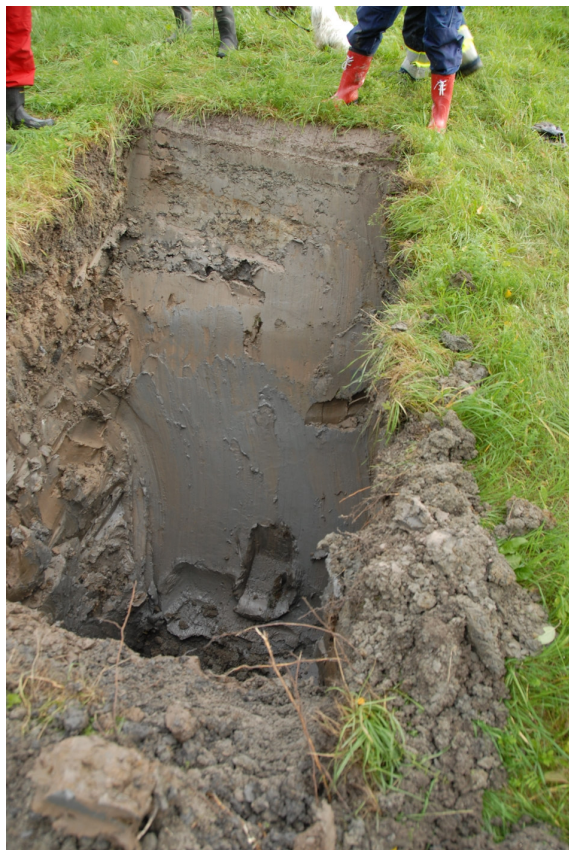
Figur 5.21. Provgrop 9 med lös lera och en ursprunglig markyta med halmrester på 2,6 m djup.
