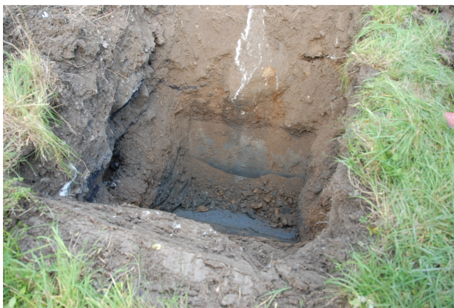
Figur 5.17. Provgrop 11. Bilden visar provgropen under utförande. På bilden syns schaktmassorna som överlagrar den naturliga blå gyttjeleran.
