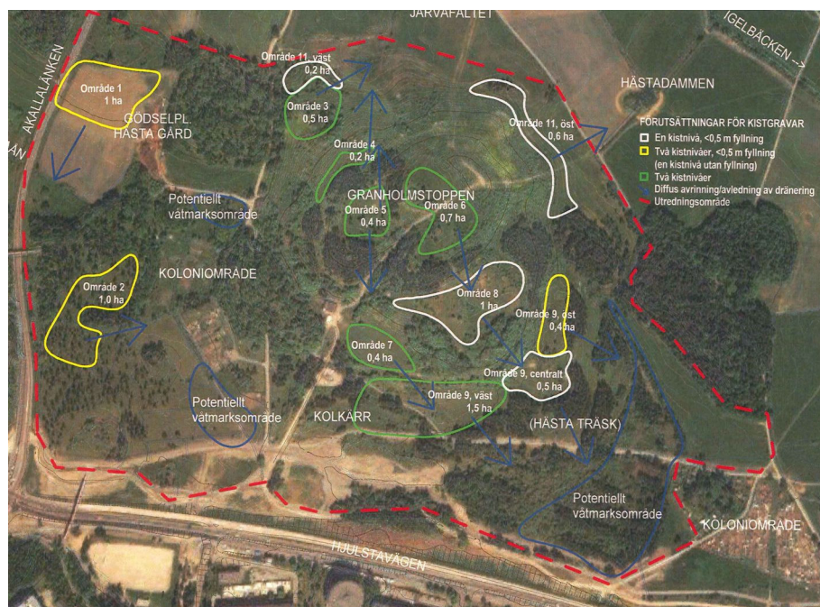
Figur 8.1. Förväntade huvudsakliga rörelseriktningar för perkolerat gravvatten från föreslagna kistgravsområden, föreslagna avledningsriktningar för dränvatten samt potentiella våtmarksområden (blå områden) som bedöms kunna återskapas i området.
