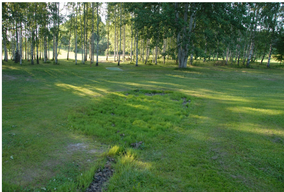
Figur 5.18. Förmodad läckagepunkt för ytligt grundvatten (temporär källa) strax söder om Provgrop 6. Provgropen utfördes vid banden i bakgrunden.
