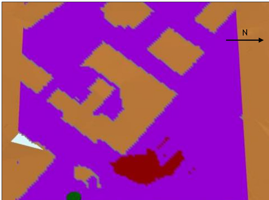
Figur 11: Områden som uppfyller kravet medelvind över 3,5 m/s högst 4 % av tiden. Översikt för områden runtom Spånga Studios, för sommarhalvåret. Nederst visas vinden utan samtliga byggnader för att tydliggöra vindförhållanden runt om byggnaden.
