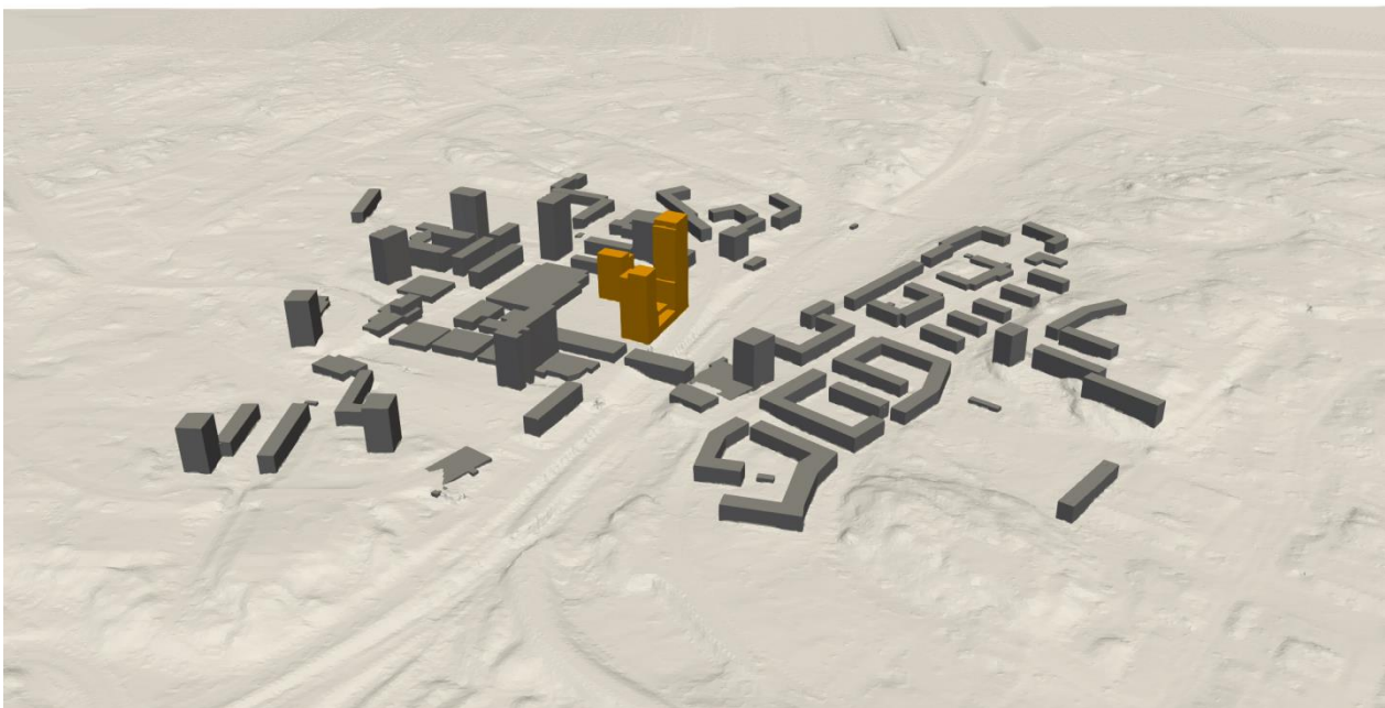
Figur 4-1: Det aktuella beräkningsområdet med inkluderade byggnadsgeometrier. I höjdläng sträcker sig beräkningsvolymen ca 200 meter över den högsta byggnadens tak.
