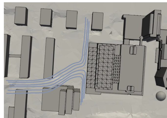
Figuren överst visar hur vindar kan passera över tidningshuset för alternativ 0. Nederst syns effekten då dessa luftflöden möter tidningshuset och pressas nedåt för att sedan styras norrut och söderut i alternativ 1.
