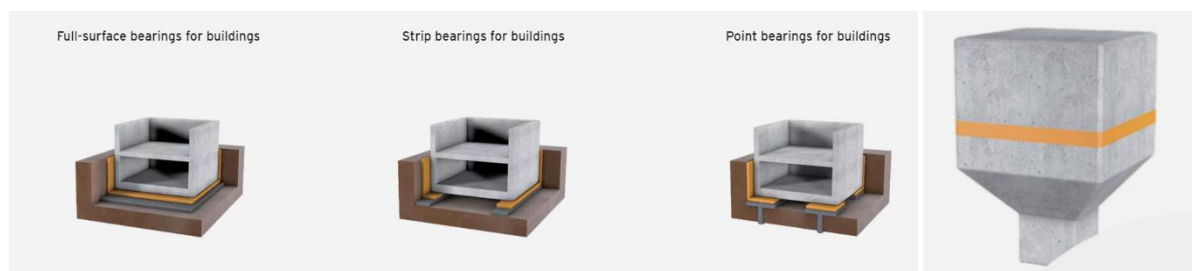
FIGUR 17. VÄNSTER: TRE OLIKA PRINCIPER FÖR STOMLJUDSISOLERING AV BYGGNADER . HÖGER: PRINCIPER FÖR STOMLJUDSISOLERING AV PELARE: (TAGEN FRÅN GETZNER.COM – EN AV FLERA LEVERANTÖRER AV VIBRATIONS- OCH STOMLJUDSISOLERING)
