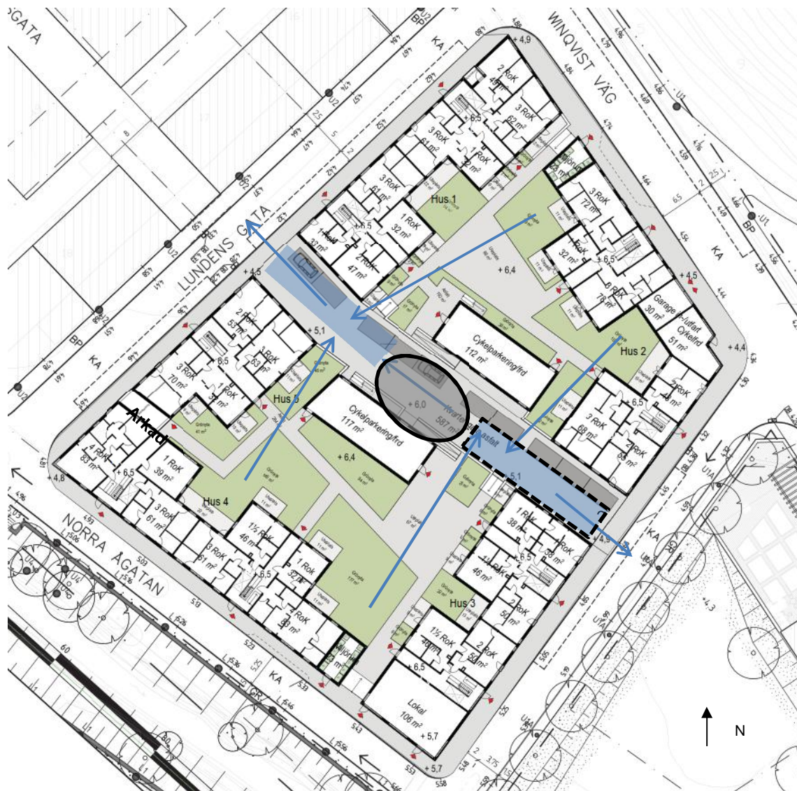
Figur 4. Östra kvarteret. Plan över gårdar, kvartersgata och byggnadernas bottenvåningar. (Illustration: Arkitekthuset, IKANO bostad 2014-05-06). Placering av dagvattenmagasin (blåfärgat, ungefärlig storlek i plan) i kvartersgata (höjd +5,1-6,3 m) ungefärligt angiven. Höjd innergårdar + 6,7m. Höjdsystem RH2000. Magasin med streckad kontur visar alternativ med tömning mot Borghöjdsvägen. Grå färgad cirkel visar ungefärlig del av gata som kommer att bli underbyggd. Höjdsättning i skissen inaktuell.
