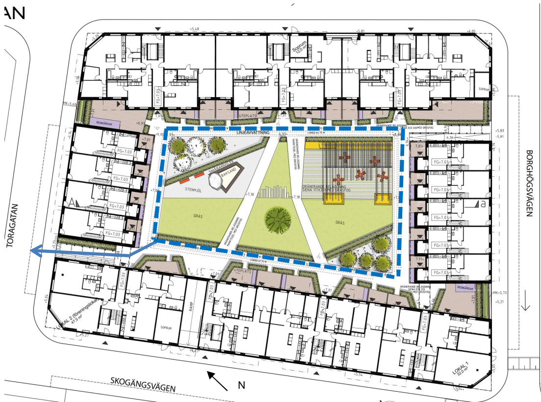
Figur 5. Södra kvarteret. (Illustration: Funkia AB, HSB 2014-12-09). Höjd innergård cirka + 6,9-7,2 m. Streckade blå linjer: Tänkta placering av römagasin för flödesutjämning. Blå pil visar anslutning till det allmänna ledningsnätet i Toras gata.
