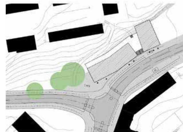
Vy och planritning över samrådsförslagens bostadshus utmed Tellusborgsvägen. En långsträckt länga med 4 + 1 våningar och en högre tvärställd byggnad med 6 + 1 våningar. Illustrationer AIX.
