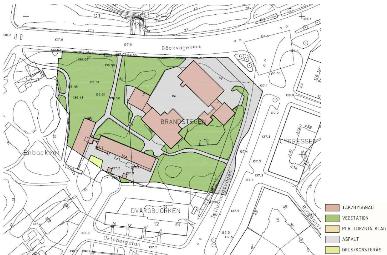
Figur 3-3: Ytor för beräkning av avrinning före exploatering
