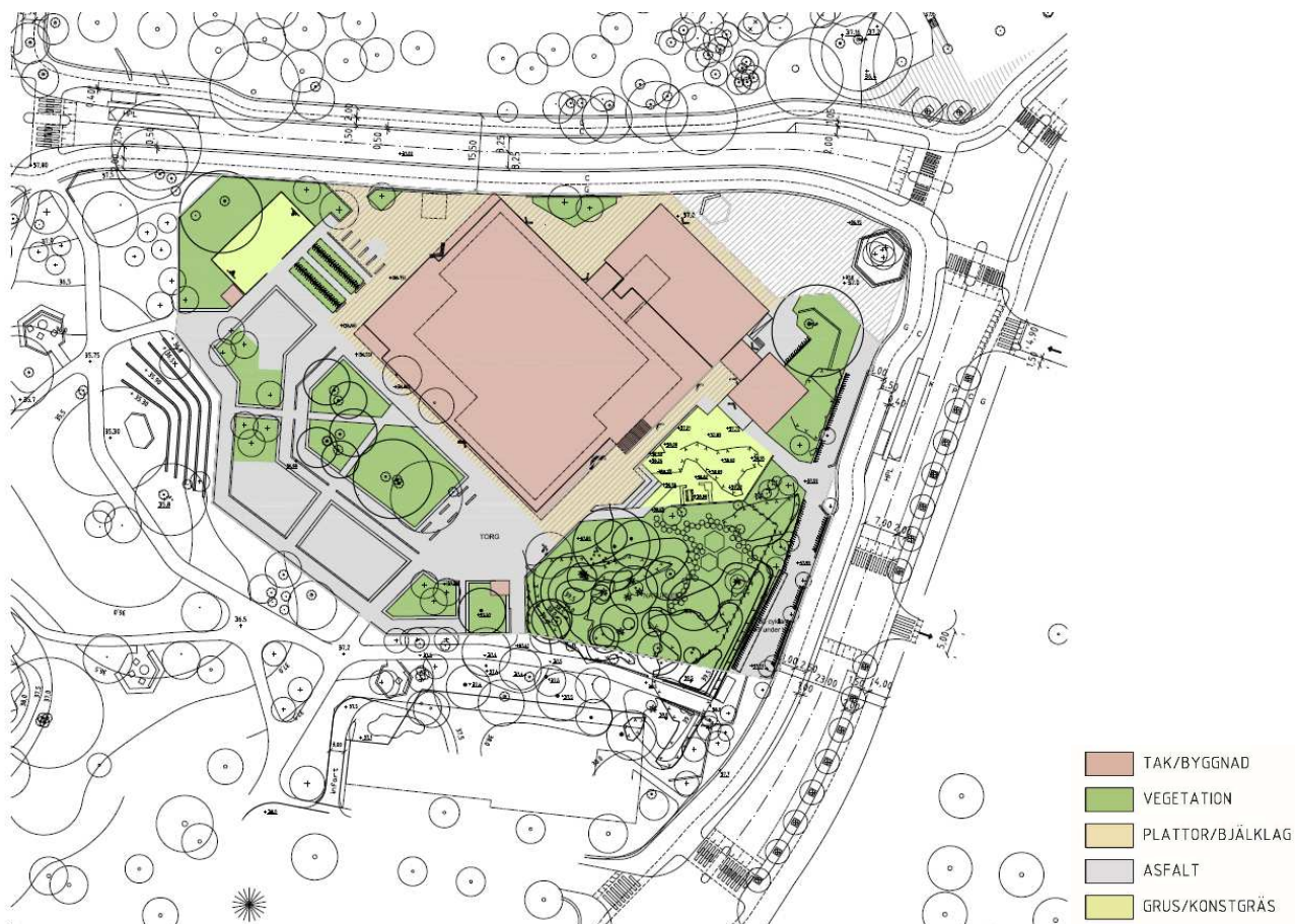
Figur 3-4: Ytor för beräkning av avrinning efter exploatering (datum: 2016-03-08)
