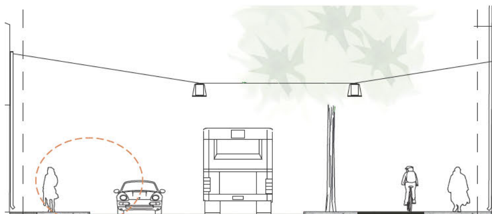
Principsektion för lokal huvudgata. Golvets beläggning på gångbana, körbana i asfalt med kantsten på 12 cm.
