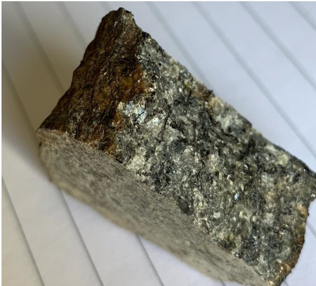
Figur 3.4 Exempel på provtagning, provpunkt 1 med svavelhalt (totalhalt) på 2800 mg/kg TS, varav 2200 mg är sulfid, med pH ca 7,5 och NPR 0,62. Materialet är syrabildande.
