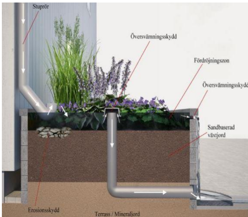
Figur 9. Principskiss över regnträdgård/växtbädd anslutning med stuprör.
