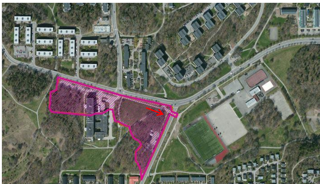
Figur 4. Avrinning till planområdet från väster. Vattnet har möjlighet att rinna in via gångtunnel (röd pil).
