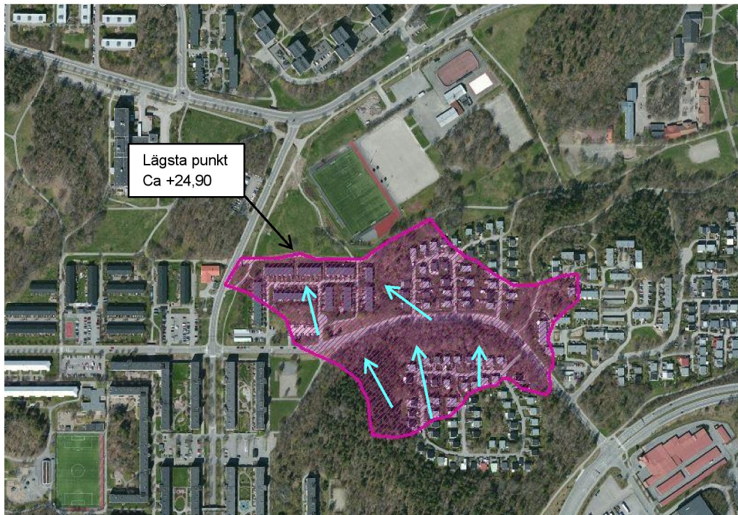
Figur 5. Bidragande avrinning till stående vatten vid grönytan i planområdets sydvästra del. Blå pilar indikerar flödesriktning.
