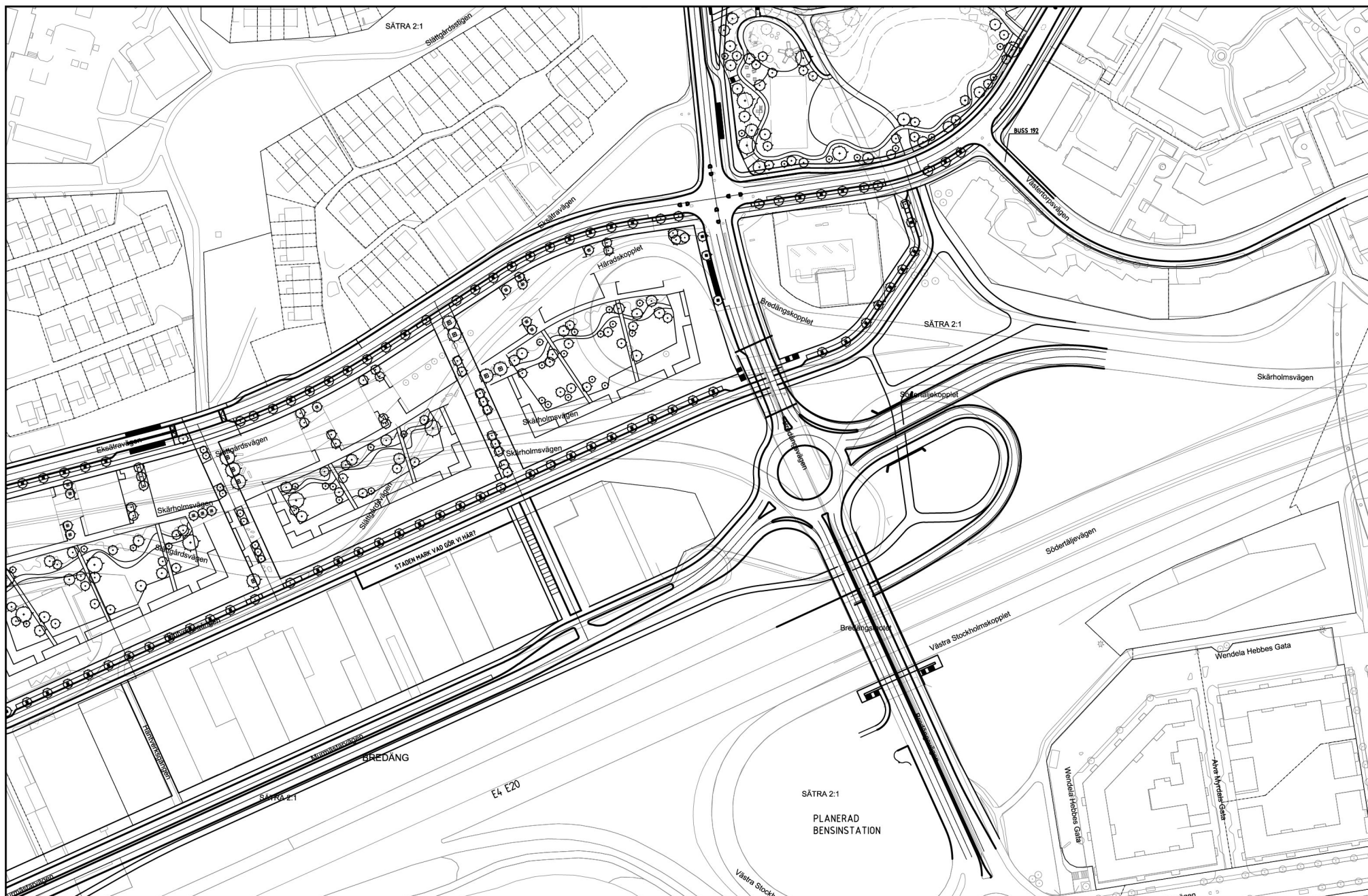
Figur 21. Utformningsalternativ med cirkulationsplats och påfartsramp från cirkulationen.
