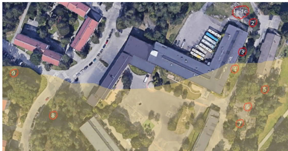
Figur 2. Placering av undersökningspunkter för radonmätning på berg.
