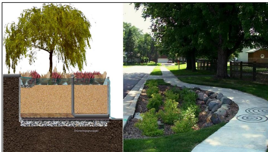
Figur 10-6. Illustration av hur en växtbädd kan byggas upp (Illustration Åsa Wellander och foto från City of Maplewood).
