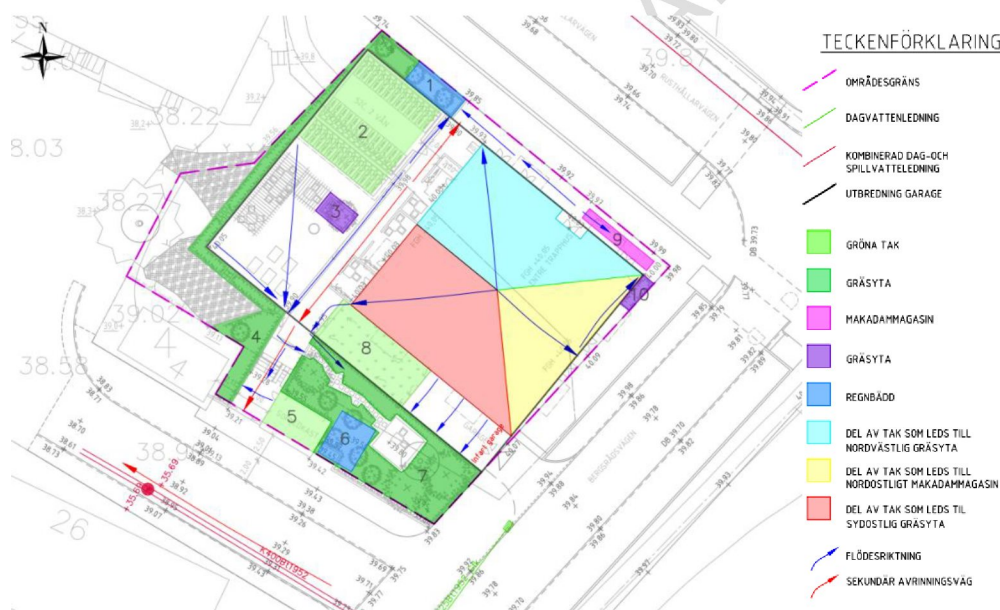
Figur 9. Primära och sekundära avrinningsvägar samt utformning av fördröjningsåtgärder
