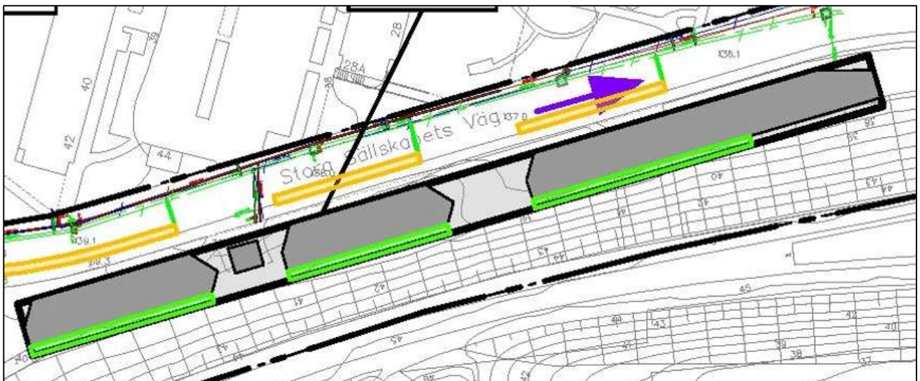
Figur 25. Föreslagen dagvattenhantering inom Kv. 6, där gröna ytor visar föreslagna regnbäddar och lila pilar visar ytlig avrinning
