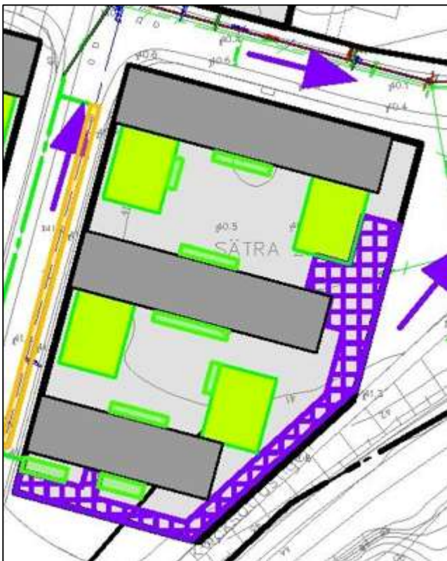
Figur 23. Föreslagen dagvattenhantering inom Kv. 4, där gröna ytor visar föreslagna regnbäddar, ljusgröna ytor är gröna tak, lila rutor motsvarar genomsläpplig beläggning och lila pilar visar yttlig avrinning
