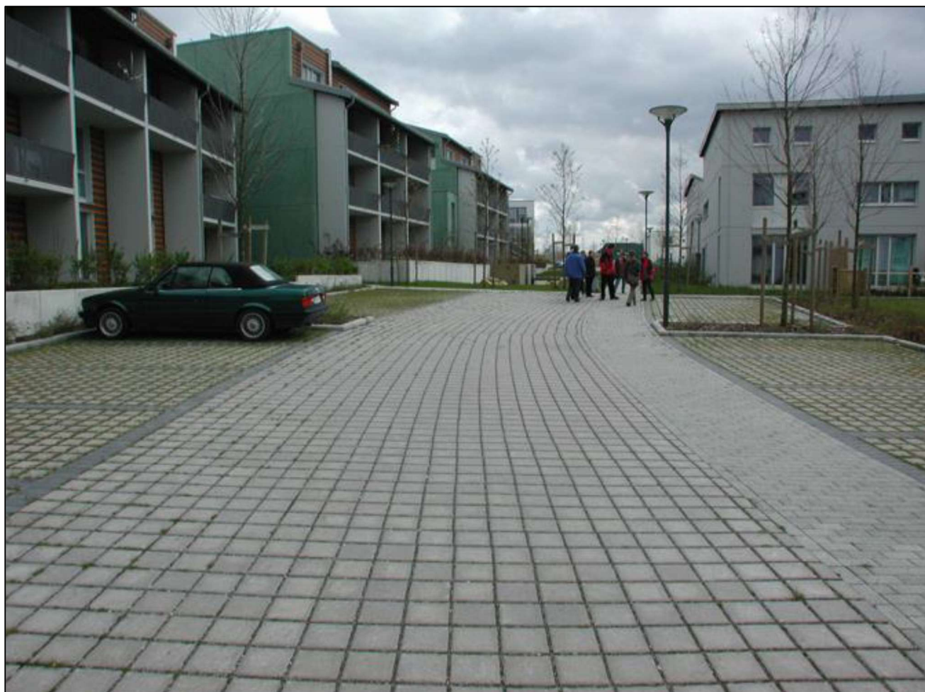
Figur 17. Parkering och gata med genomsläpplig beläggning (Foto: Norconsult).
