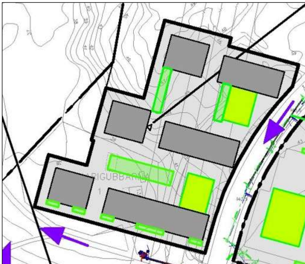
Figur 20. Föreslagen dagvattenhantering inom Kv. 1 där gröna ytor visar föreslagna regnbäddar, ljusgröna ytor är gröna tak och lila pilar visar yttlig avrinning
