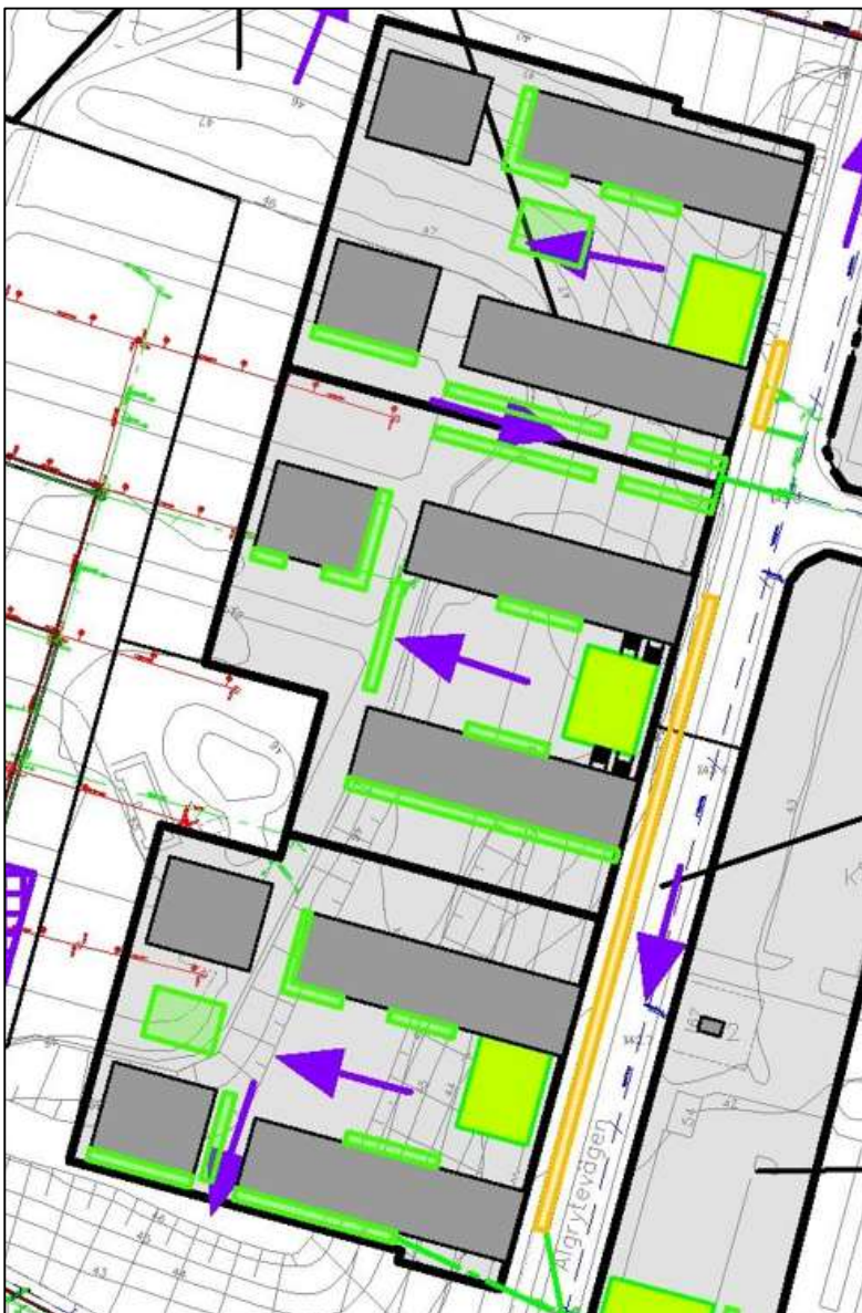
Figur 21. Föreslagen dagvattenhantering inom Kv. 2 – A, B och C, där gröna ytor visar föreslagna regnbäddar, ljusgröna ytor är gröna tak och lila pilar visar ytlig avrinning
