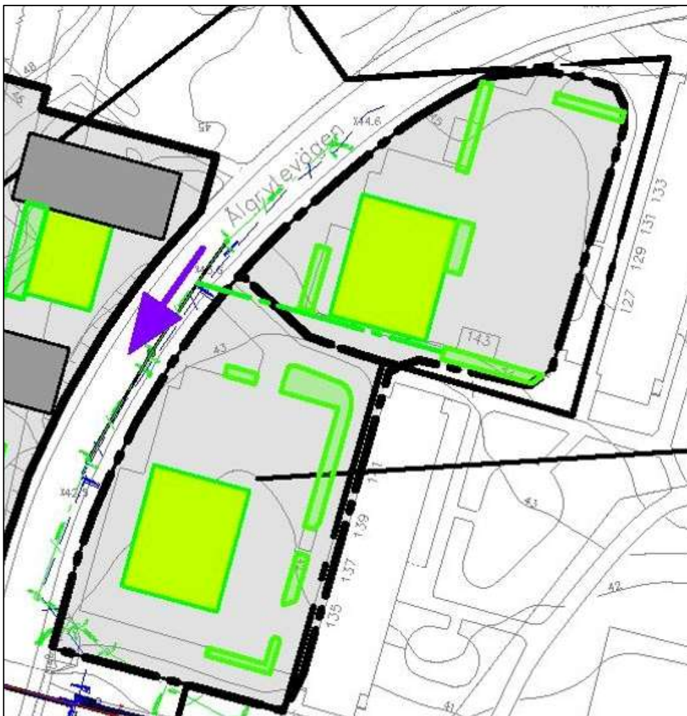
Figur 24. Föreslagen dagvattenhantering inom Kv. 5 – C och D, där gröna ytor visar föreslagna regnbäddar, ljusgröna ytor är gröna tak och lila pilar visar ytlig avrinning
