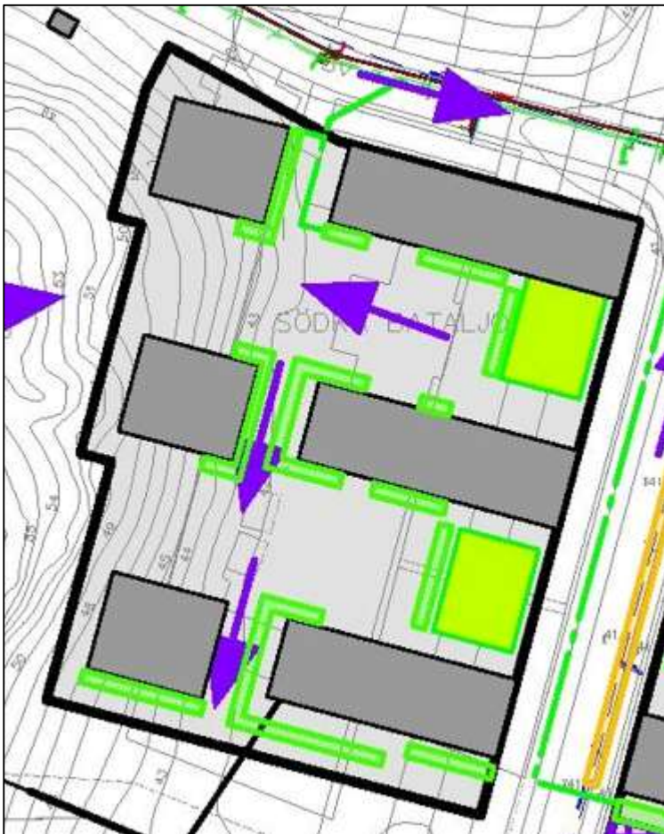
Figur 22. Föreslagen dagvattenhantering inom Kv. 3, där gröna ytor visar föreslagna regnbäddar, ljusgröna ytor är gröna tak och lila pilar visar ytlig avrinning
