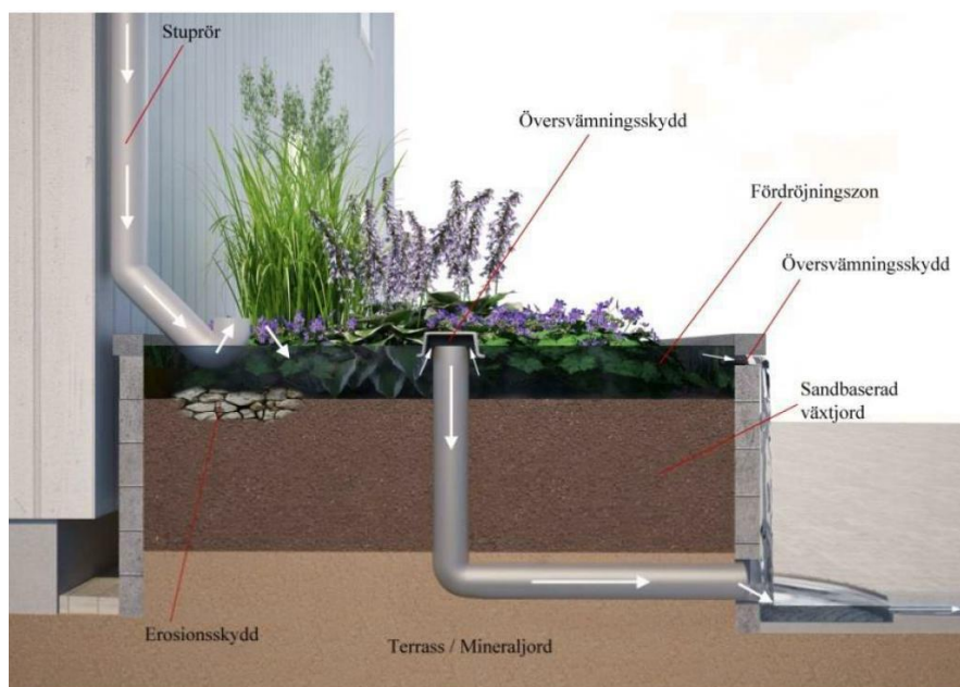
Figur 17. Principskiss för biofilter upplyft konstruktion. (Bildkälla: Grågröna systemlösningar för hållbara städer, Inventering av dagvattenlösningar för urbana miljöer, Vinnova 2014.)
