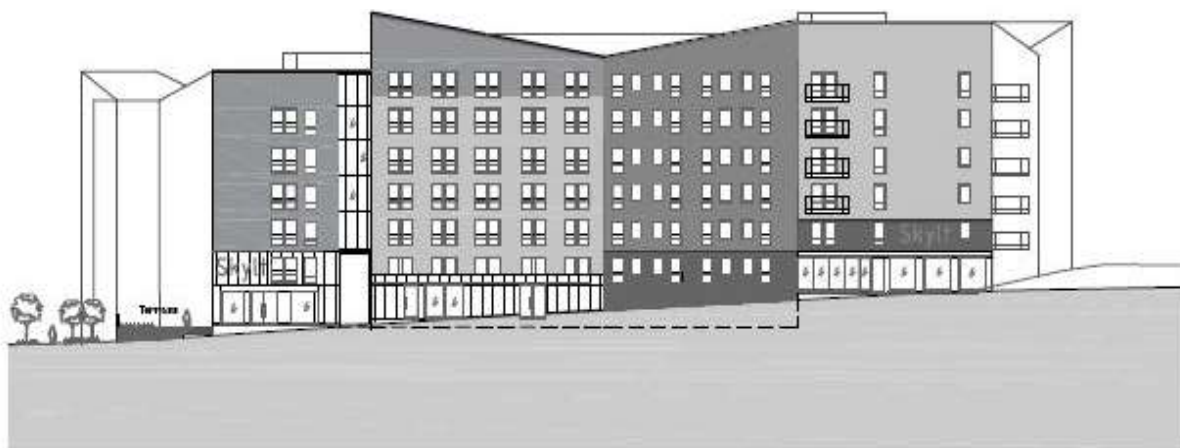
Bild 16. Hus A och D, som enligt förslaget får loftgångar och motfallstak. Fasadens material föreslås bli skiffer i bottenvåningarna och däröver putsade ytor. På bilden ses fasad mot norr.
