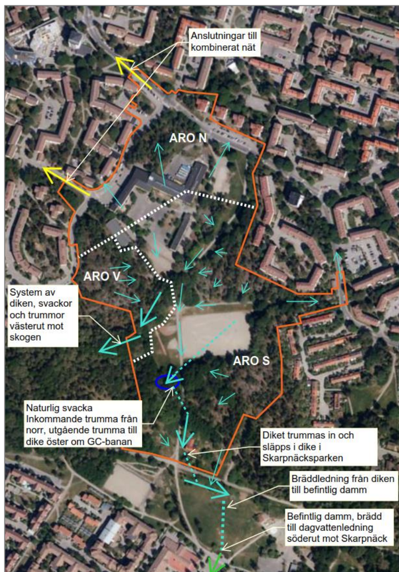
Figur 7. Befintlig avrinningssituation. Blå heldragna linjer visar ytlig avrinning (de större indikerar dike, de mindre generell flödesriktning).
