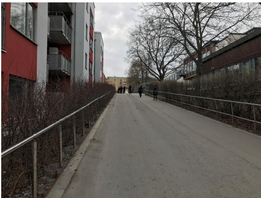
Figur 9 Hållsättrastigen, foto taget i riktning mot Säteria centrum. Hållsättrastigen har en otillgänglig lutning på denna sträckan, där räcken troligen är implementerat för att förbättra tillgängligheten på stråket. Räckena har även infälld belysning.
