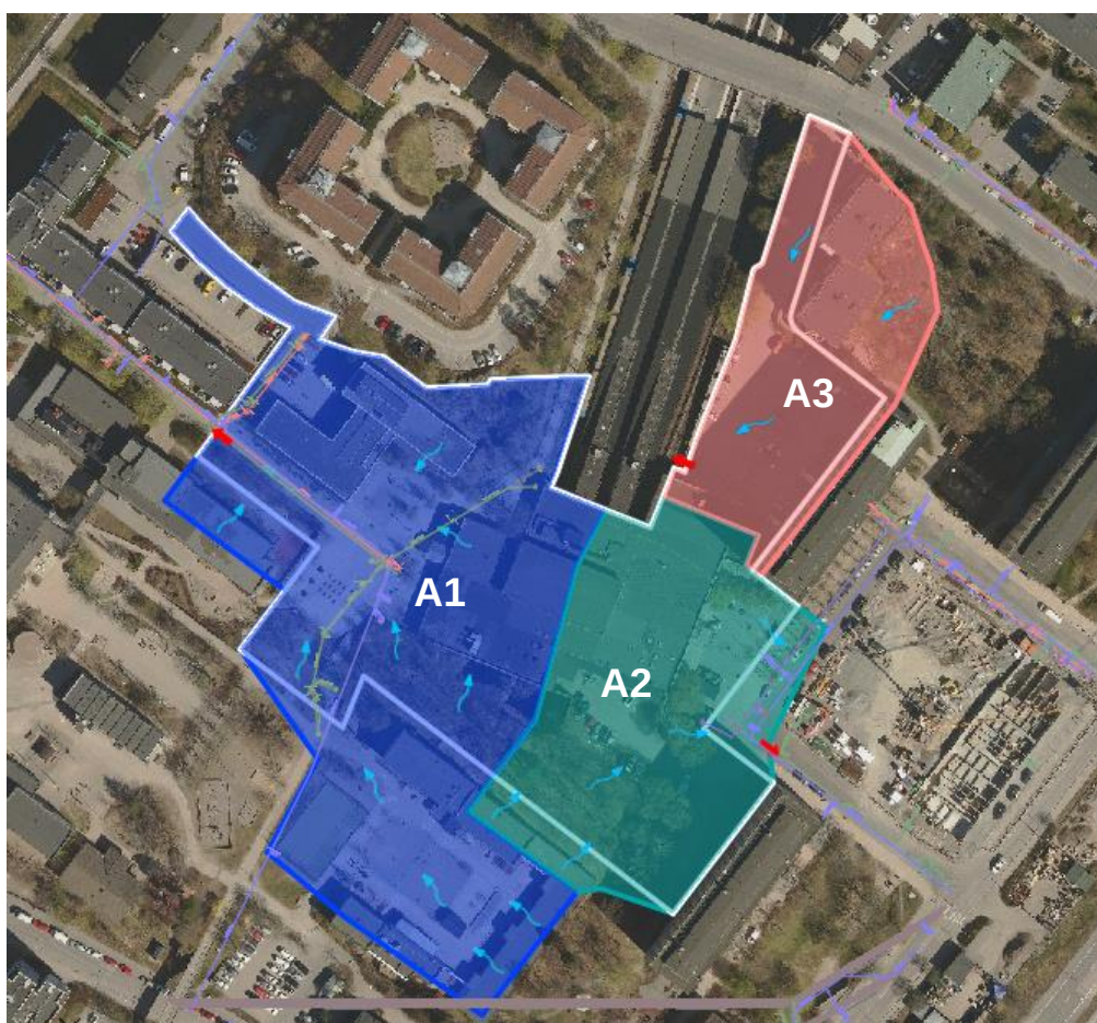
Figur 4. Översikt över befintlig avvattnings inom planområdet. Avvattningen visas med blå flödespilar. Röda pilar indikerar utloppen. Planområdet är markerat med vit linje. Befintliga dagvattenledningar markerade med grön linje.
