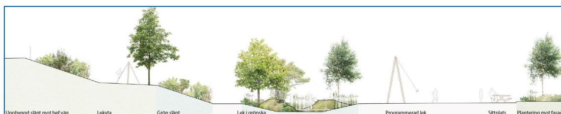
Figur 9-4 Skissförslag från Topia (2021-01-29) till utformning och höjdsättning av skolgården i norr som framförallt ska kunna hantera dagvatten. Figuren visar sektion B-b som är utmärkt i Figur 9-2.
