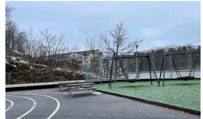
Fallskyddsområden ser ut att vara i underkant i mått och stötdämpningen är ev inte godkänd.
