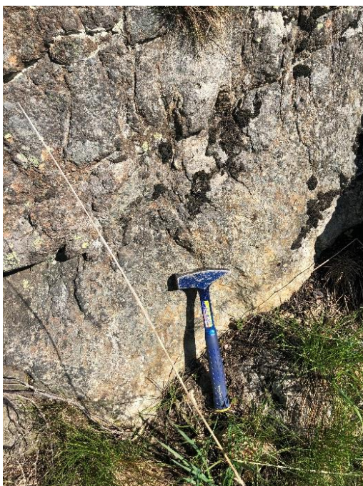
Figur 3-9. Mindre rostutfällningar på bergslänt i område D.
