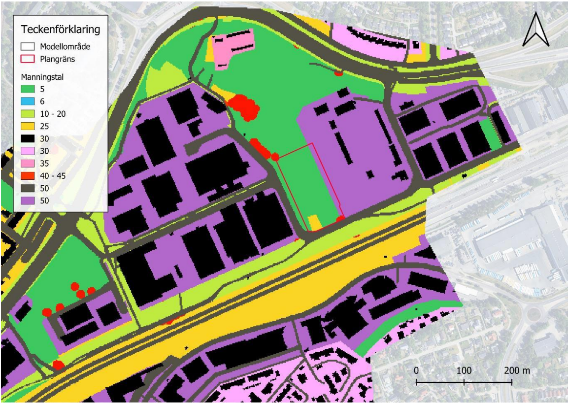
Figur 10. Mannings tal för befintligt scenario, baserat på Stockholms skyfallsmodell (2024).
