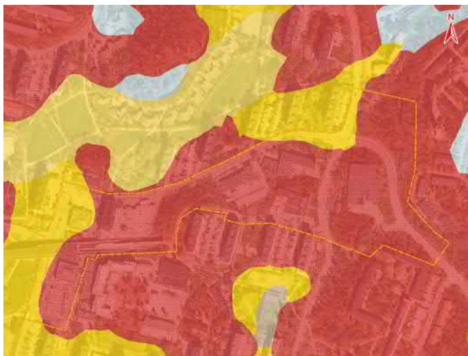
Figur 3 Utdrag från SGU:s jordartskarta över detaljplaneområde (markerat med gul streckad linje. (SGU, 2021). Röd yta anger yttligt berg och gul yta anger lera, ljusgrått anger yttligt moränlager.
