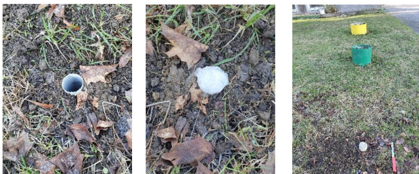
Figur 4. WMS-provtagaren hängdes på 0,3m djup i ett rör tätt packat i marken. Röret förtäpptes sedan med plast, jordsvål och sten.
