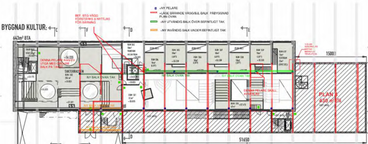
Bild 6.1.4 Plan 4, bjälklagsbalkar påbyggnad visas i rött som information. Utvändig avväxlingsbalk markerad i grönt, olika gröna färger för olika dimensioner, invändig balk i orange, blått är nya pelare. Befintliga betongväggar runt trapphus nyttjas för bäring.
