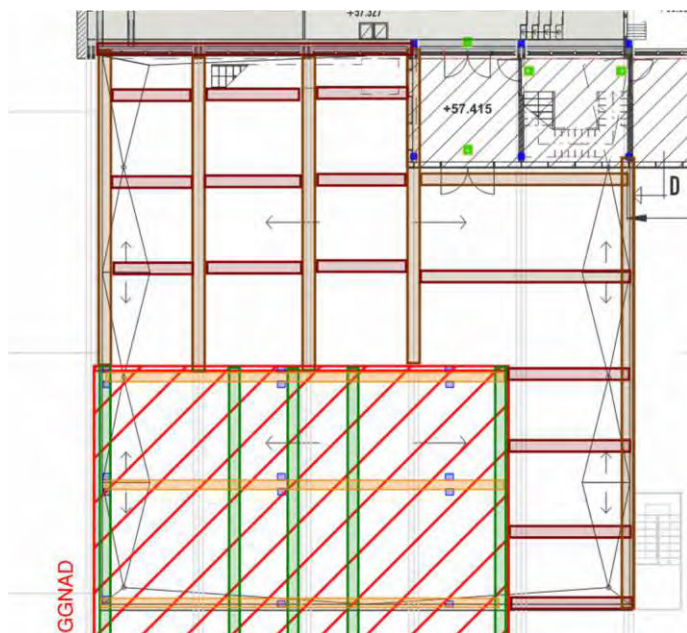
Bild 6.4.2.1 Princip för utförande av terrass med ett rutnät av stålbalkar från balk påbyggnad till fasad hus 1 samt hus 2 där lastfördelande stålbalk över befintliga pelare i fasad fungerar som upplag.
