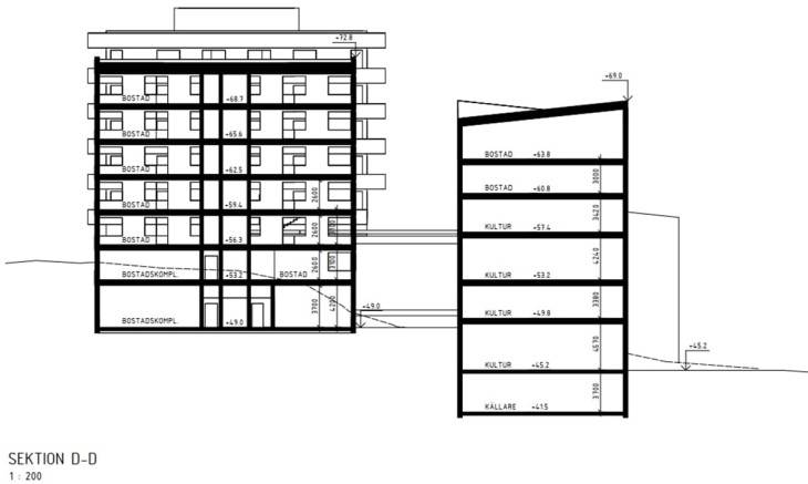
Figur 6. Tvärsektion ny byggnad till vänster, befintlig byggnad till höger, daterad 2024-08-27.
