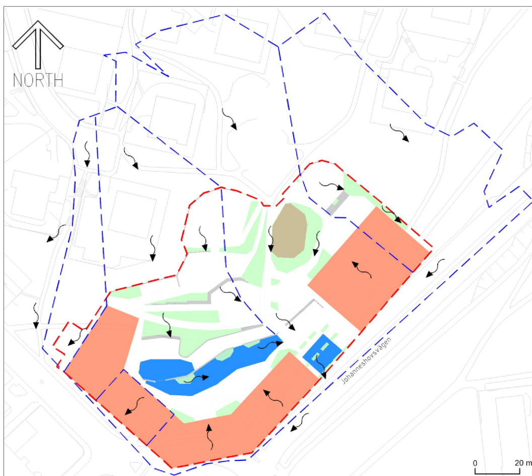
Figur 12.1. Förslag på framtida skyfallshantering. Blå ytor markerar tillfälliga översvämningsytor
