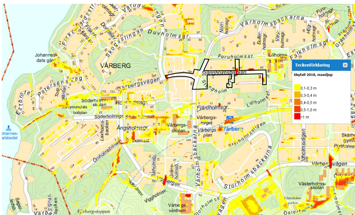
Figur 12. Maximalt vattendjup för marköversvämning vid 100-årsregn enligt Stockholm Vattens skyfallsmodellering 2018. Enligt färgskala uppstår >1 m maxdjup vid gångtunneln vid Stångholmsplatsen (Dataportalen, 2019)
