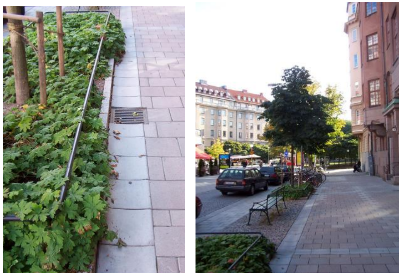
Figur 9. Vänstra bilden visar en vanlig rännstensbrunn som leds till skelettjorden intill. Högra bilden visar träd planerade i skelettjord på Erik Dahlbergsallén (Bildkälla: Stockholm vatten och avfall)
