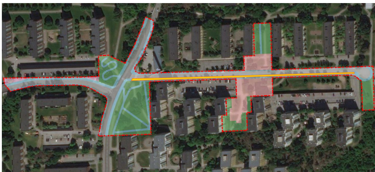
Figur 11. Det gulmarkerade området visar det platsbehov som krävs för anläggning av skelettjord inom utredningsområdet för att uppnå åtgärdskravet om rening av 20 mm per kvadratmeter hårdgjord yta. Dimension av skelettjord enligt principskiss från StormTac. Blåmarkerade ytor visar GC-bana.
