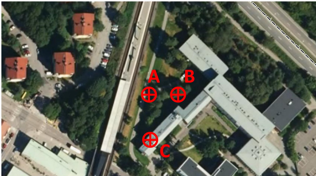
Figur 7. Ungefärliga mätpositioner för vibrationsgivare (accelerometer). Accelerometer på spett i mark (A), på berg i dagen (B) och på bottenplatta inomhus i källare (C). Den lodräta accelerationen mättes för ett antal tågpassager i båda riktningarna för varje mätposition.
