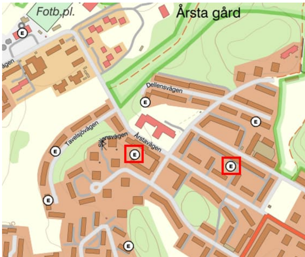
Figur 7. Kartbild från EBH stödet över potentiellt förorenade områden i närområdet till aktuell fastighet (rosa byggnad i figurens centrala del). De båda kemtvättarna där klorerade lösningsmedel använts är markerade med en röd fyrkant.
