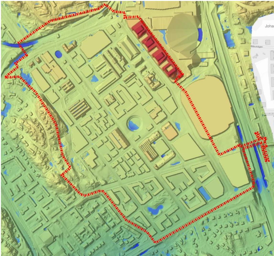
Figur 20 Översvämningsutbredningar med beräknade maximala vattendjup över 20 cm visas i blått. Djup över 20 cm bedöms orsaka begränsningar i framkomlighet för mindre fordon inklusive ambulanser.
