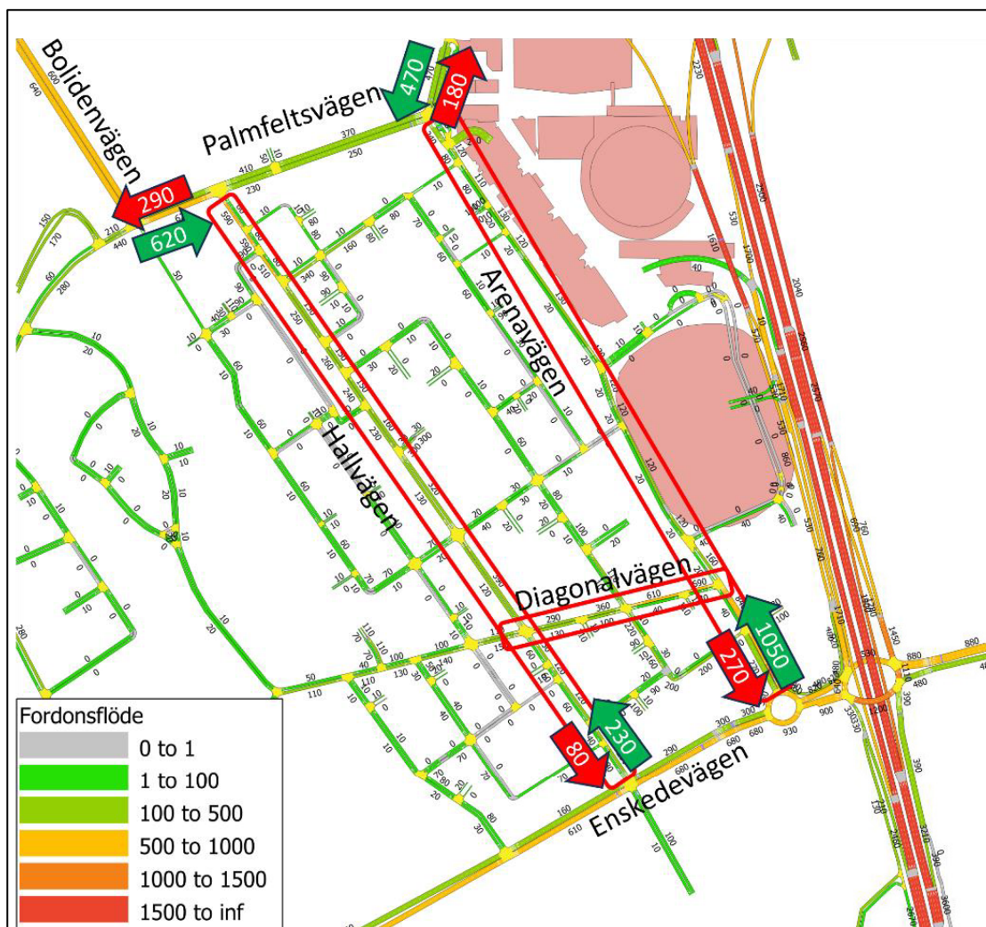
Figur 22. Översikt över simulerade flöden in i och ut ur Slakthusområdet med signalreglerad fyrvägskorsning Enskedevägen/Hallvägen/Kolonivägen under förmiddagens maxtimme för prognosår 2040.
