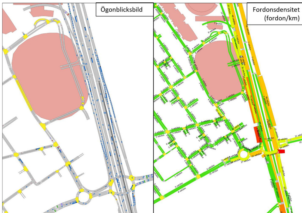
Figur 15. Simulerad densitet under eftermiddagens maxtimme visar på köbildning längs gula, orangea, och röda sträckor (observera att korsningspunkterna kan vara gula utan att det innebär köbildning). Ögonblicksbilden är hämtad från mitten av den simulerade timmen.
