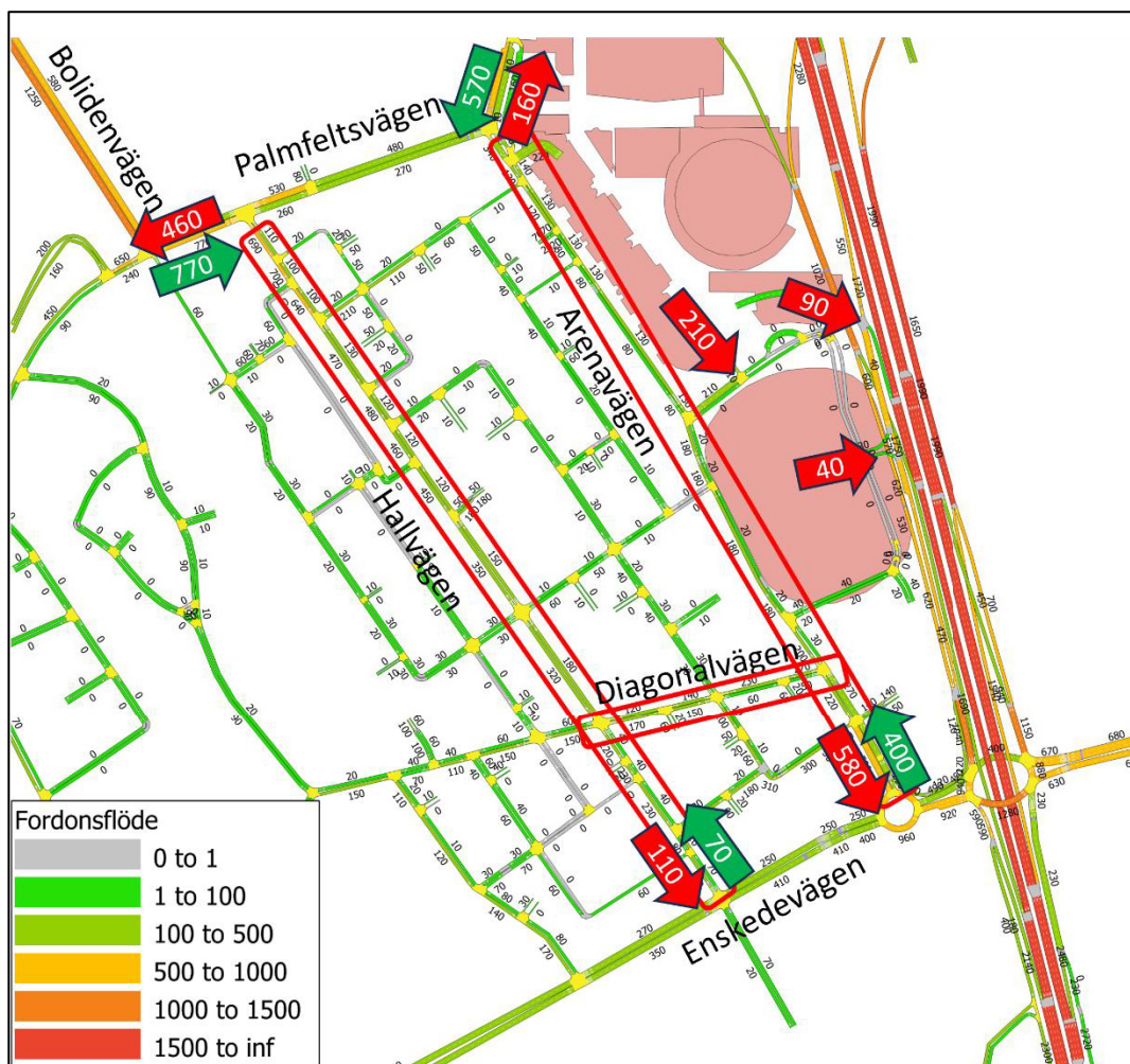
Figur 25. Översikt över simulerade flöden in och ut ur Slakthusområdet med signalreglerad fyrvägs korsning Enskedevägen/Hallvägen/Kolonivägen under förmiddagens maxtimme för prognosår 2040.
