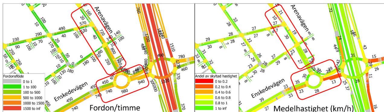
Figur 10. Simulerad trafiksituation i Slakthusområdets sydöstra del under förmiddagens maxtimme prognosår 2040. Siffror ovanför vägvägnitt i bild till höger visar den simulerade medelhastigheten. Färgkodningen på länkarna i höger bild indikerar simulerade medelhastigheter som ligger under skyltad hastighet. Rödare färg indikerar en större hastighetssänkning och grönare färg indikerar en medelhastighet närmare friflödeshastighet för vägen.
