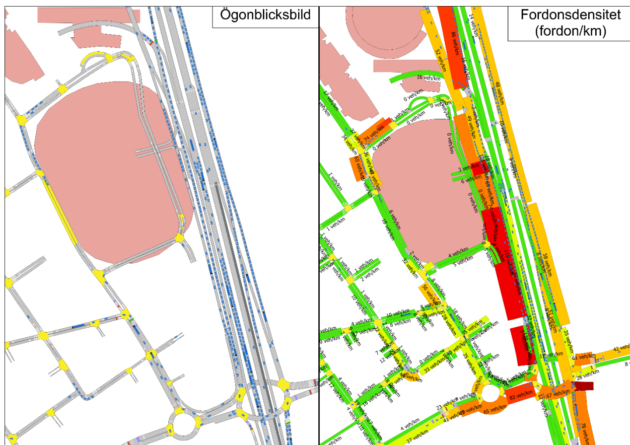
Figur 18. Ögonblicksbild av simulerad trafiksituation vid Sofielundsrondellen inför evenemang. Simulerad densitet visar på köbildning längs gula, orangea, och röda sträckor (observera att korsningspunkterna kan vara gula utan att det innebär köbildning). Ögonblicksbilden är hämtad i mitten av den simulerade timmen.
