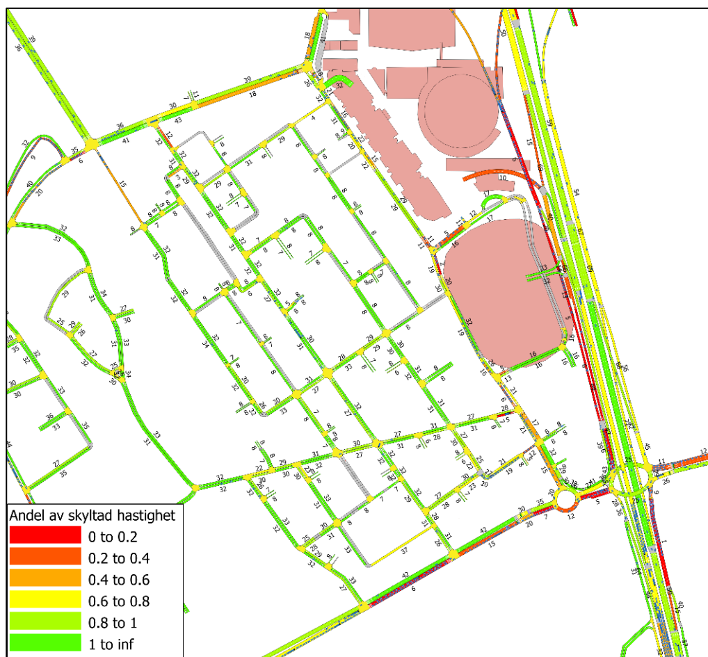
Figur 17. Översikt över simulerade hastigheter in till och ut från Slakthusområdet, inför evenemang prognosår 2040. Siffror ovanför vägavsnitt i bild till höger visar den simulerade medelhastigheten. Färgkodningen på länkarna indikerar simulerade medelhastigheter som ligger under skyltad hastighet. Rödare färg indikerar en högre hastighetssänkning och grönare färg indikerar en medelhastighet närmare friflödehastighet för vägen.
