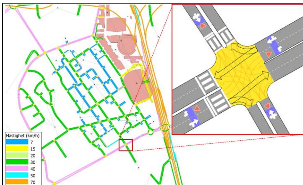
Figur 6. Signalreglerad fyrvägs korsning Enskedevägen/Kolonivägen/Hallvägen. Svarta pilar i den inzoomade bilden indikerar rörelser som har trafikprioritering. Lilamarkerade delar av vägar representerar fordonsdetektorer för aktivera/förlänga en signalfas.
