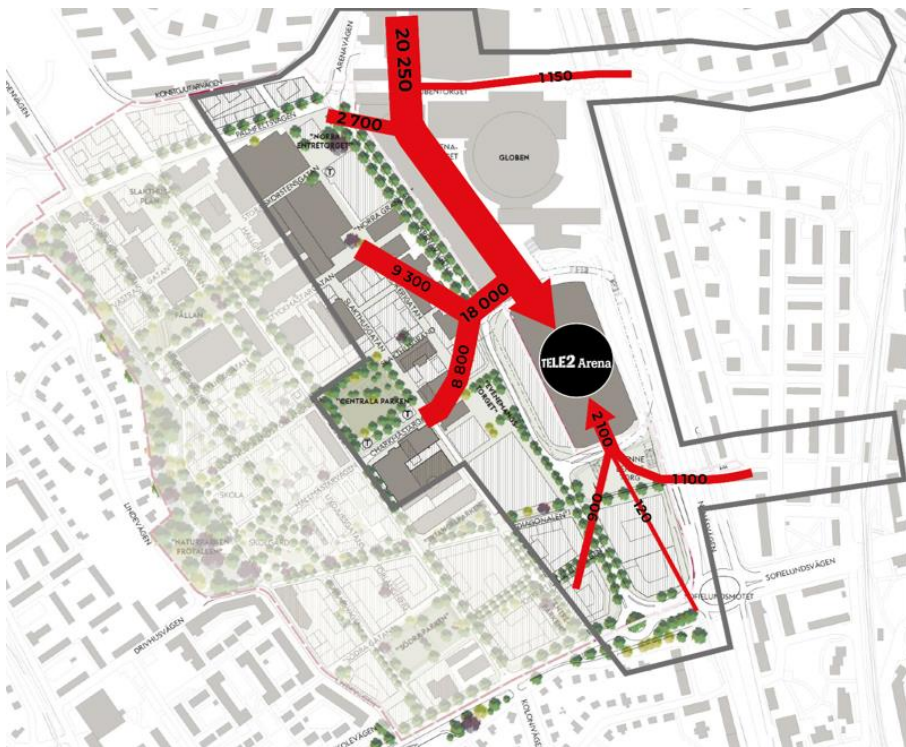
Figur 7 Kartan redovisar schematiska gångflöden mot olika riktningar från simuleringsområdet i scenario 2. Flöden med målpunkt inom området (t.ex. parkering) redovisas inte.
