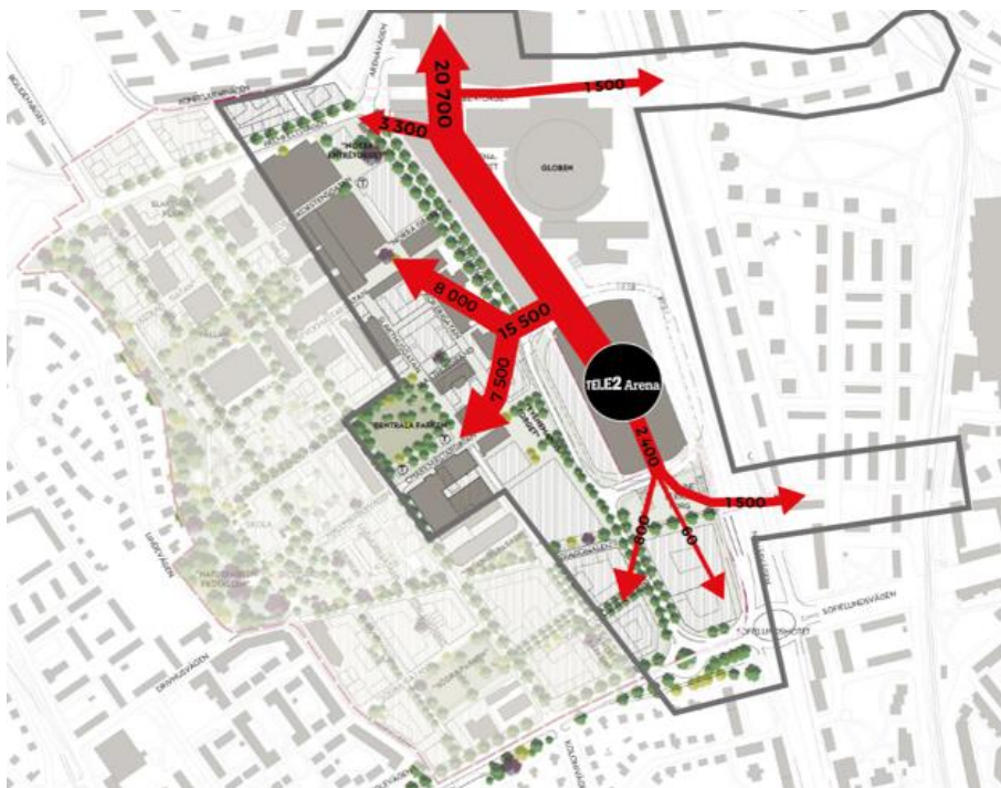
Figur 8 Kartan redovisar schematiska gångflöden mot olika riktningar från simuleringsområdet i scenario 3. Flöden med målpunkt inom området (t.ex. parkering) redovisas inte.
