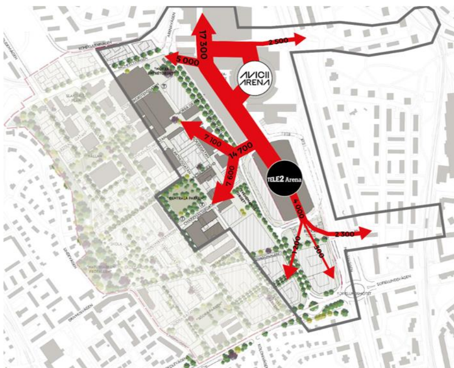
Figur 6 Kartan redovisar schematiska gångflöden mot olika riktningar från simuleringsområdet i scenario 1. Flöden med målpunkt inom området (t.ex. parkering) redovisas inte.
