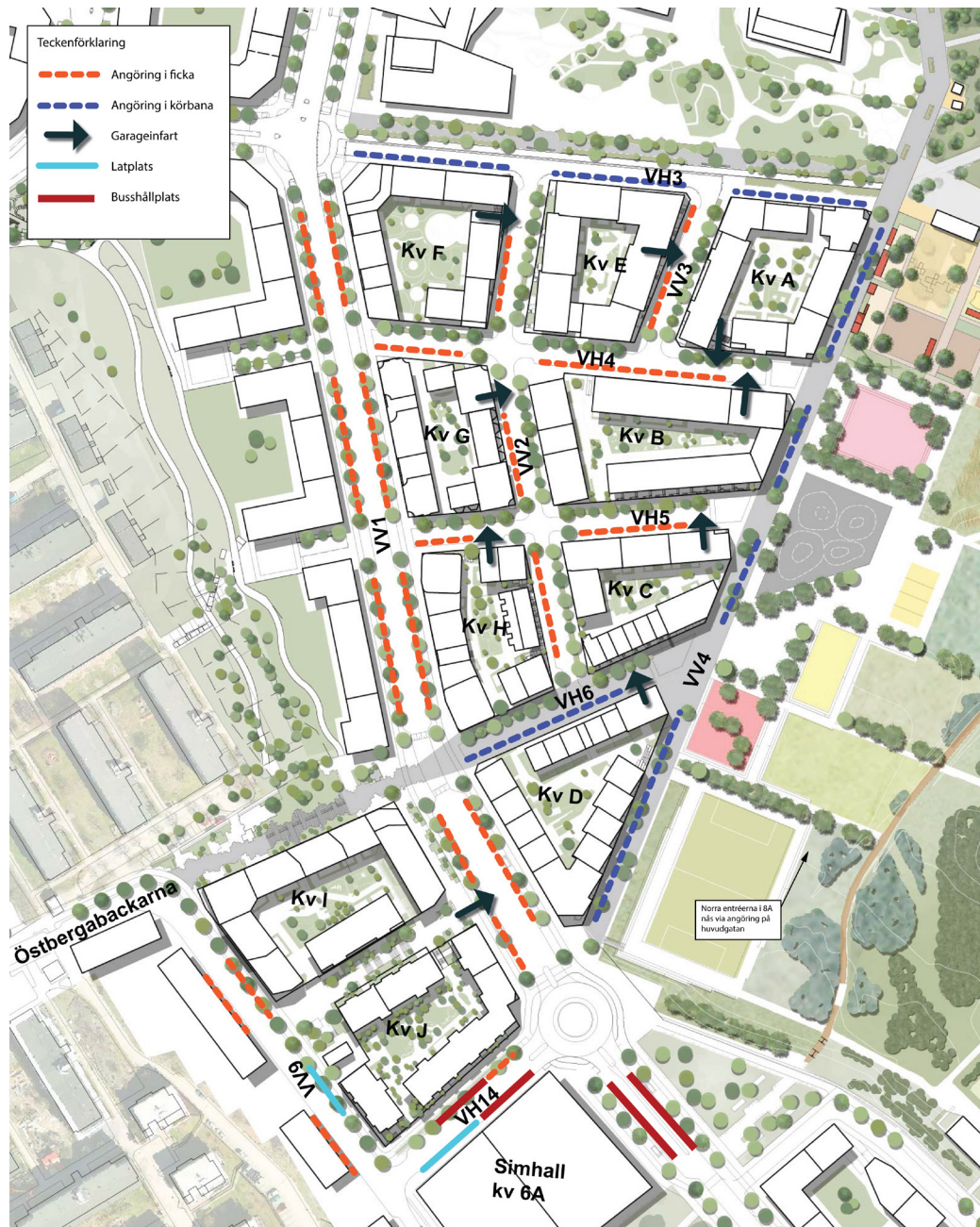
Figur 23. Angöringstyor och garageutfarter. Det är även möjligt att angöra längs gatorna på den trädplanterade sidan samt på vändtyr där planen är att p-förbud gäller.
