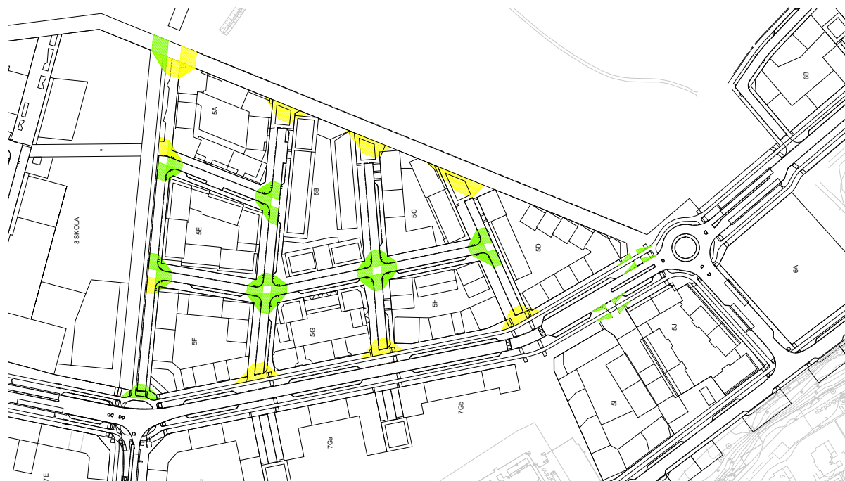
Figur 20. Utsnitt ur ritning visandes sikttrianglar på 10 meter från respektive gata i korsningar. Grön färg visar "god sikt" där inga hushörn ligger inom sikttriangeln och gul färg visar "acceptabel sikt" där mindre del av hushörn inkräktar på sikttriangel.
