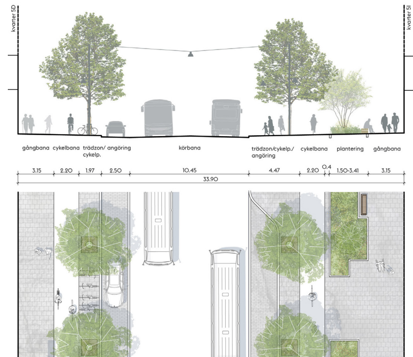
Figur 9. Sektion och planillustration Östbergavägen/VV1 mellan kv I+J och kv D. (Karavan)
