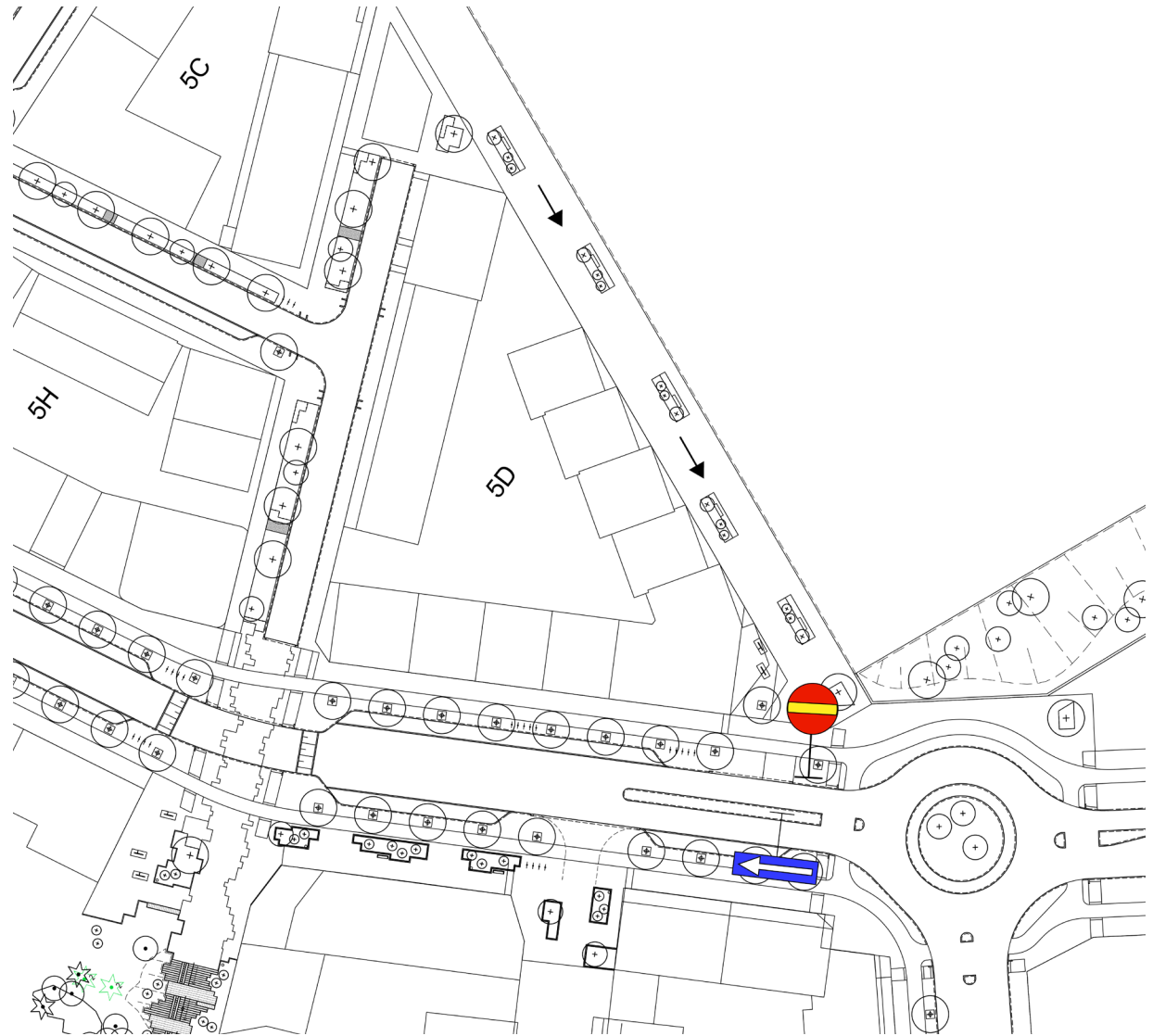
Figur 19. Skiss över gångfartsgatans möte med Östbergavägen/VV1. Notera att vägmärken är inlagda för att visa princip och ska inte tolkas som de är placerade i slutligt läge.
