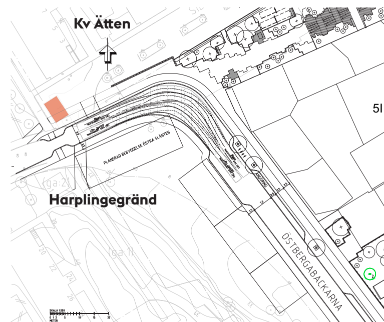
Figur 14. Körspår i den skarpa kurvan på Östbergabackarna. Boggibuss och 12 meters lastbil (Lbn) kan mötas. Den planerade bebyggelsen i Östra slänten är under utredning.
