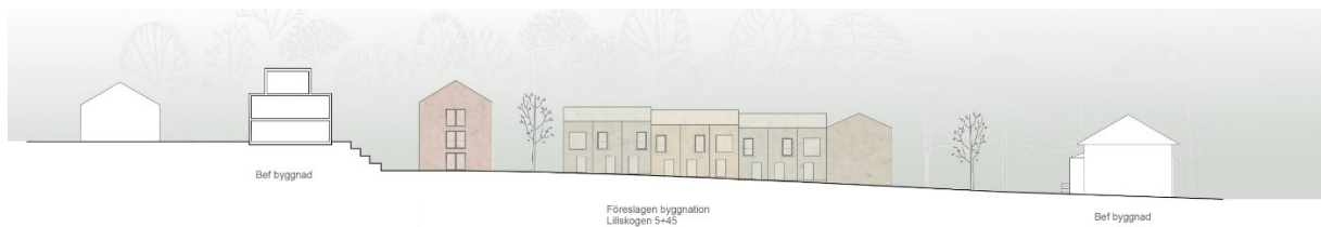
Sektion i nord-sydlig riktning som visar möjliga höjdförhållanden mellan nya och befintliga hus (Ateljé Nord).
