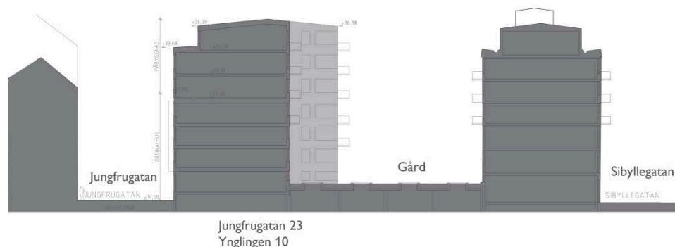
Sektion mot söder genom fastigheten Ynglingen 10 med föreslagen påbyggnad.
