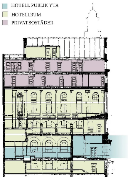
Längdsnitt - Ny Användning (Överlagrad på bygglov från 1926)
