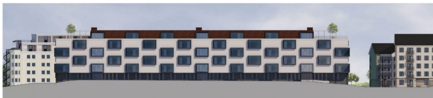
Ny byggnad: fasad mot E4/E20 Södertäljevägen. Fasad mot E4 ska utformas med inbyggd korridor med stora glaspazier. Takterrass med pergola och bullerskyddad glaspazier syns i bilden. Larsson Arkitektur AB.
