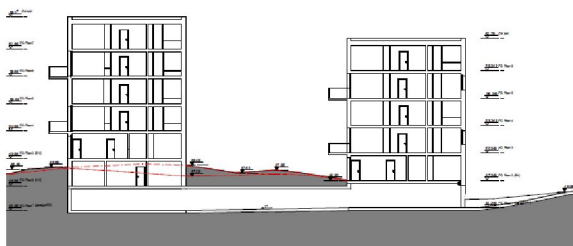
Sektion för de två södra byggnaderna längs Lidköpingsvägen som visar garagets placering och hur höjdskillnaderna hanteras. Vy från Lidköpingsvägen. Arklab.
