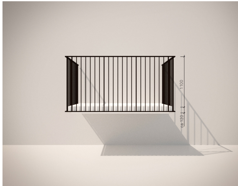
PINNRÄCKE, "DOLD" INFÄSTNING
